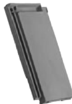
Tuile de ventilation 1 trou Ø 5 mm capacité de ventilation: 2.730mm²
